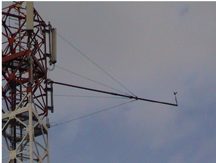
Držać anemometra velike dužine koji se koristi za ispitivanje uticaja rešetkastog stuba bazne stanice na merenje brzine vetra
